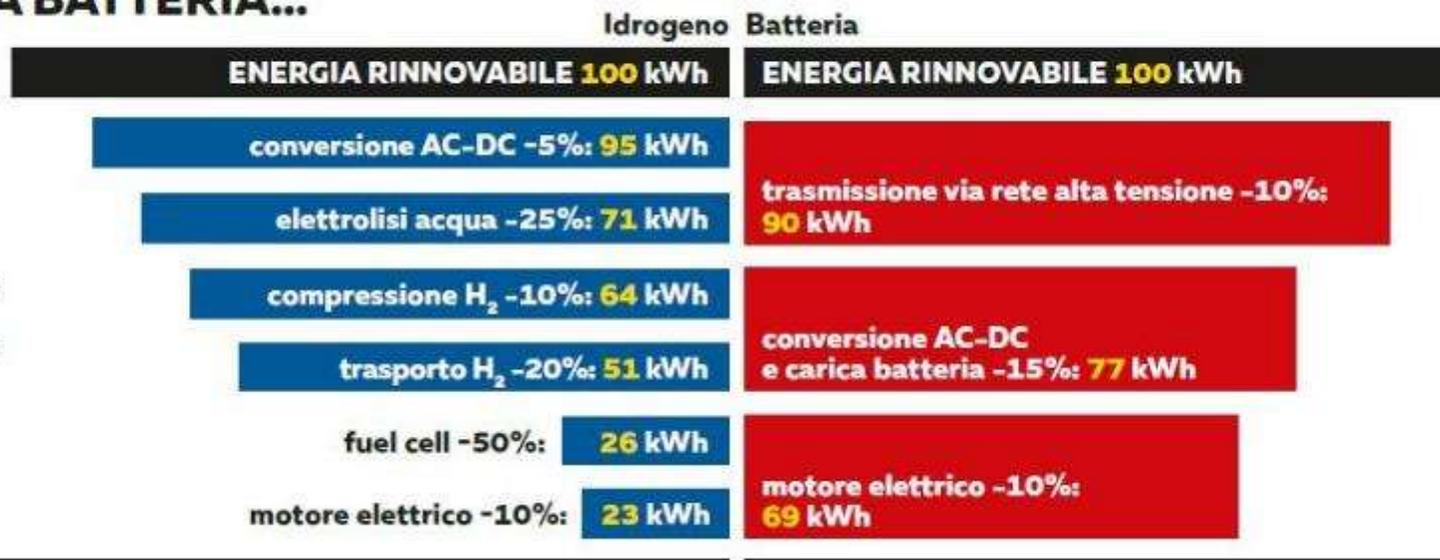
Se ci si limita a considerare l'utilizzo dell'energia elettrica, le celle a combustibile sono assai meno efficienti delle batterie.
