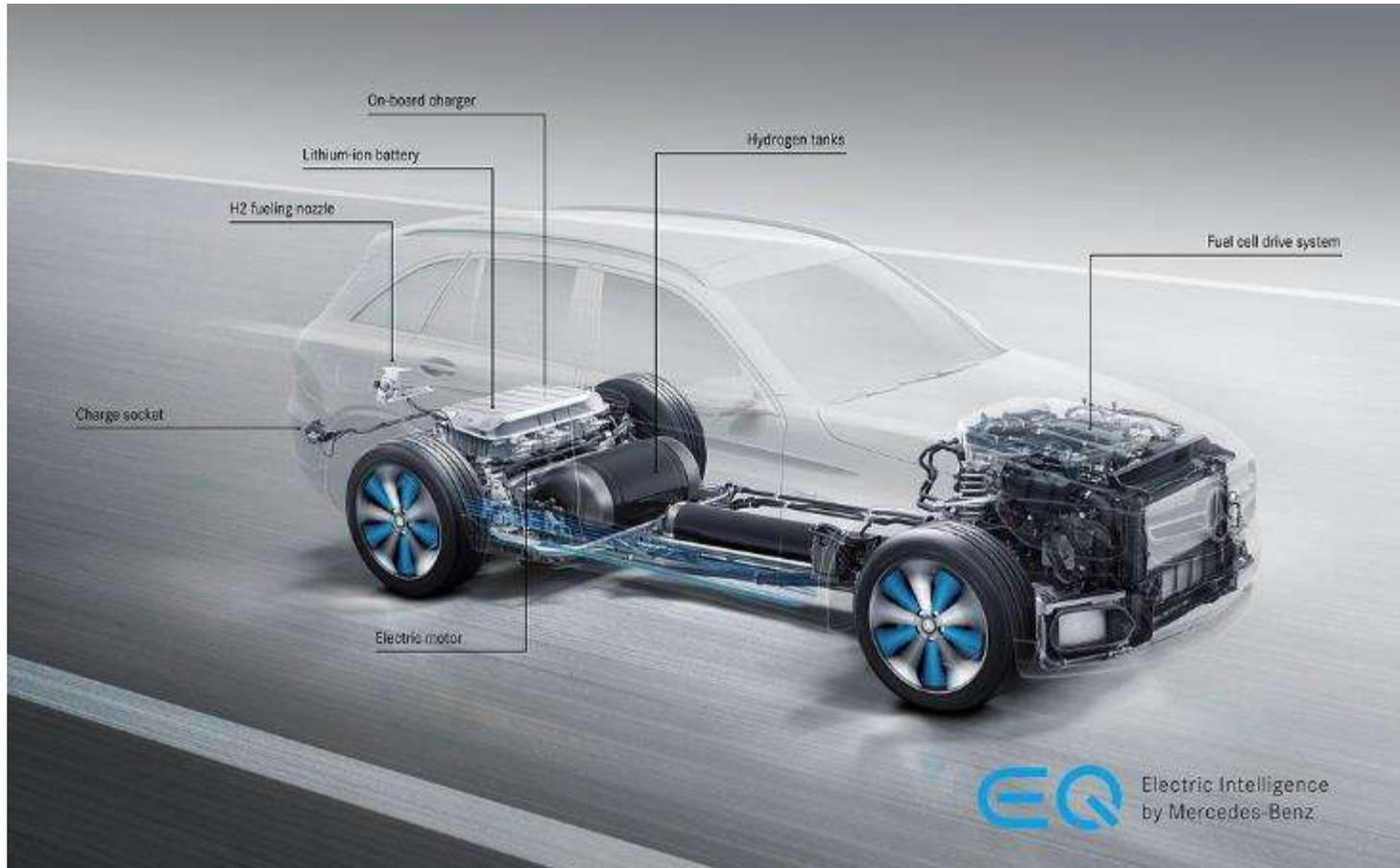
Al posto delle batterie, si possono usare le celle a combustibile, che vengono alimentate da idrogeno e aria e generano energia elettrica e acqua. Oltre ad avere tempi «di ricarica» ridotti, a pari autonomia comportano una minor massa dei serbatoi del gas rispetto alle batterie.
